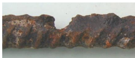
Afb.5. Putcorrosie bij chloride aantasting
